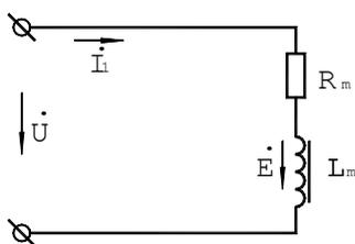
Для исследования катушки с разомкнутым магнитопроводом используется схема, приведенная на рис. 15 лабораторной работы N5.
